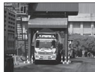
การจ่ายถ่านหินใส่รถบรรทุก
